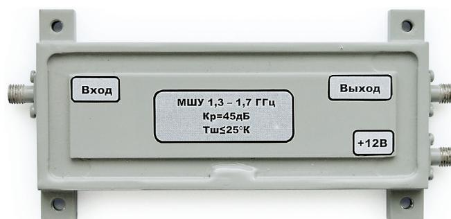
**Рис.2.** МШУ с малым коэффициентом шума L-диапазона, предназначенный для радиоастрономических наблюдений
