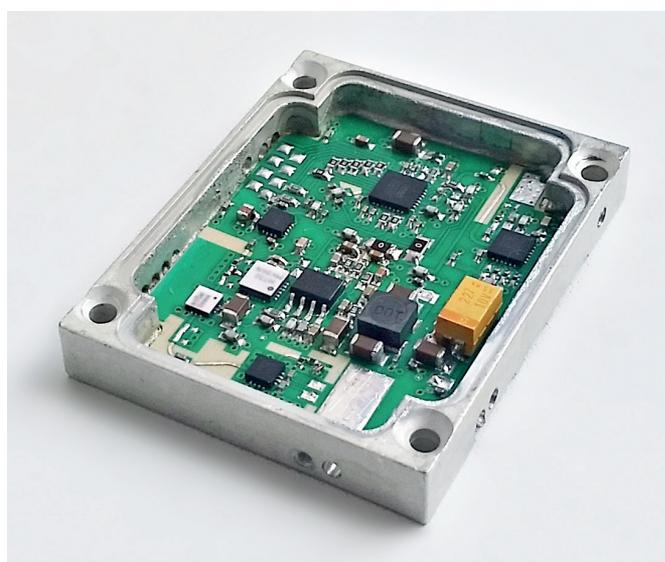
Рис.5. Генератор Ку-диапазона на основе ГУН Ку-диапазона
