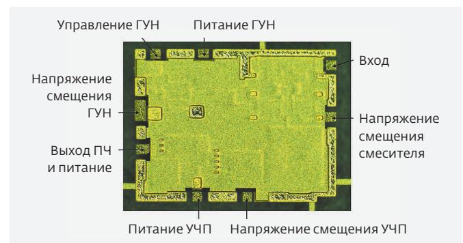
Рис.1. Фотография кристалла МИС ПС
