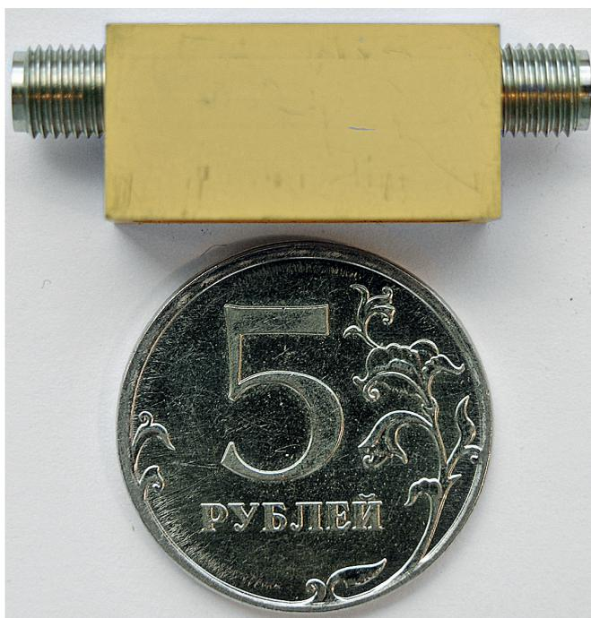
**Рис.4.** Модуль МШУ Ка-диапазона
