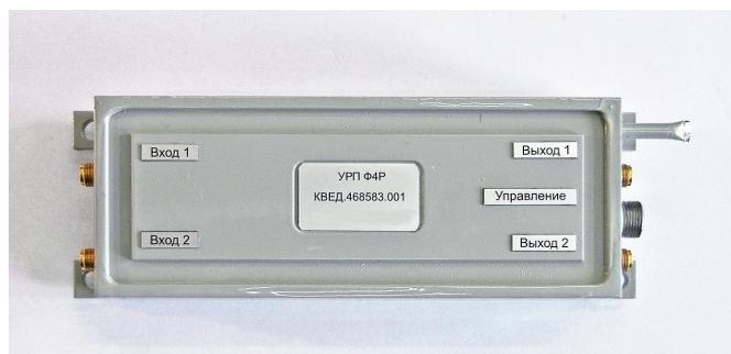
**Рис.4.** Внешний вид устройства разделения поляризации С-диапазона
